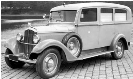
Sanitní provedení postavené na podvozku Škoda 430 D roku 1934 již s modernější maskou chladiče.
