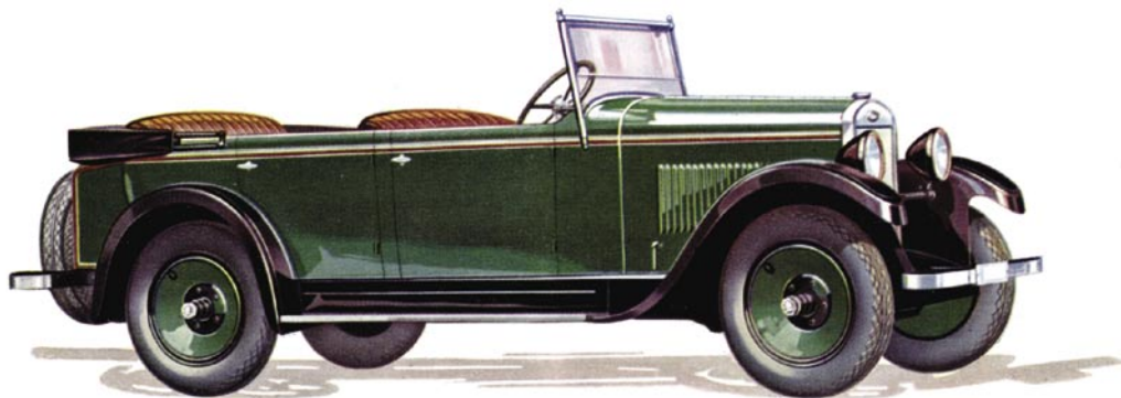
Nejlevnější provedení karosérie typu phaeton s jednoduchou sklápěcí střechou. Boční okna bývala v rámu a nad dvěře se pouze nasazovala.
