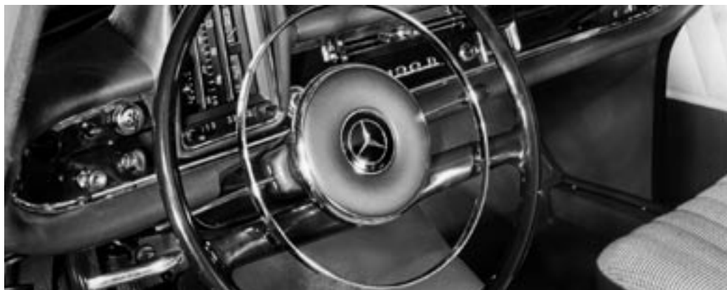
Přístrojová deska s výrazným „bezpečnostním“ čalouněním po svém obvodu a s neobvyklým tvarem sdruženého přístroje umístěném ve vysoké „kapličce“. Na svisle orientovaném rychloměru – v závislosti na rychlosti jízdy vystupoval zvláštní sloupec podobně jako v kapiláře teploměru.
