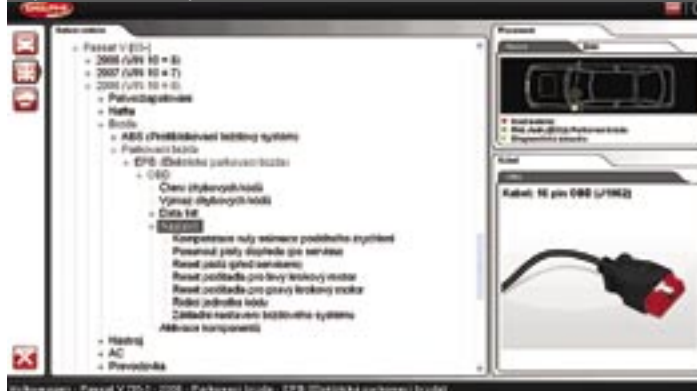
Výměna brzdových destiček u vozů s elektrickou ruční brzdou
