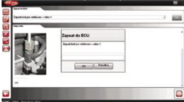
Přirazování vstříkovacích trysek k řídicí jednotce
